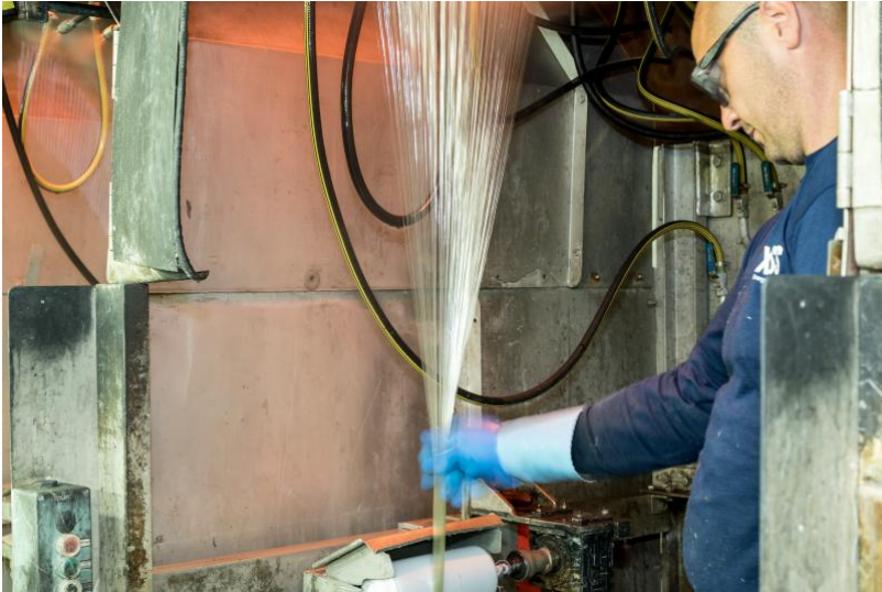
Glasfaserproduktion von LANXESS am Standort Kallo bei Antwerpen, Belgien. Foto: LANXESS AG
